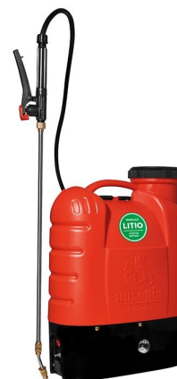
022000 Pompa a spalla con batteria al litio 12v/10Ah indicatore stato di carica regolatore pressione pressione 1,5 - 4 bar durata carica circa 8 ore reversibile peso kg.3,7 serbatoio lt.16
